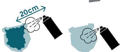
2 Den Kleber aus 25 cm Entfernung auf die rückseite des zu klebenden Objektes sprühen indem sie an den Rändern beginnen und dann die Mitte besprühen. Das spray bildet ein weissliches Pulver.
